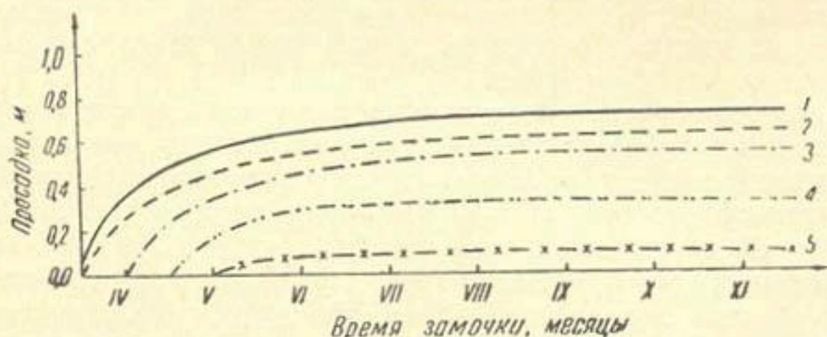
Рис. 2. Динамика просадки глубинных марок во времени: 1 — кривая марки, установленной на глубине 2 м; 2 — то же 4 м; 3 — 6 м; 4 — 10 м; 5 — 15 м
