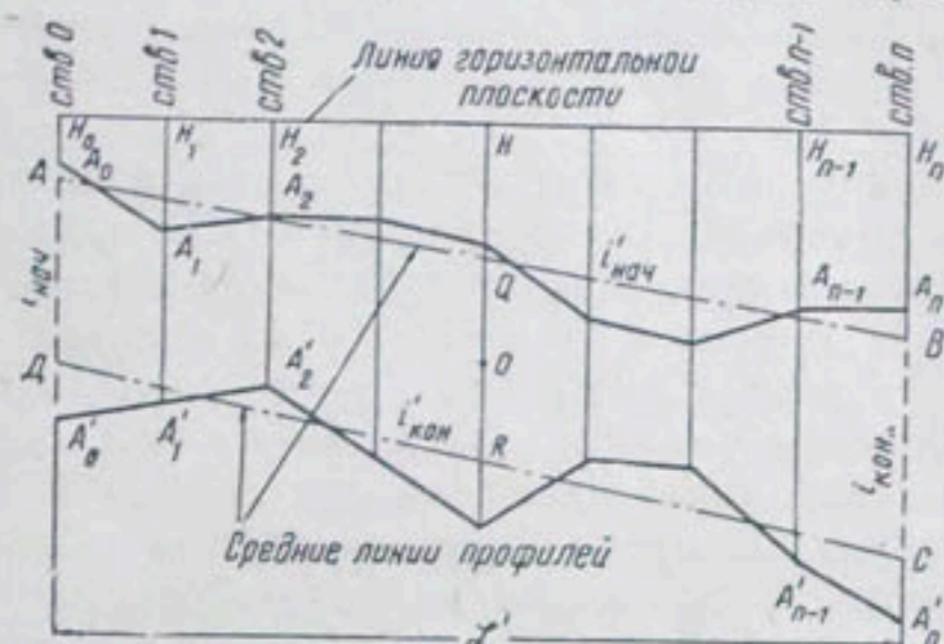
Рис. 2. Профили, построенные по точкам начал и концов средних линий профилей створов: A_0, A_1, A_2, \dots, A_n — точки начал средних линий профилей створов; A'_0, A'_1, A'_2, \dots, A'_n — точки концов средних профилей створов; H_0, A_0, H_1, A_1, \dots, H_n, A_n — ординаты средних линий; H'_0, A'_0, H'_1, A'_1, \dots, H'_n, A'_n — ординаты концов средних линий; HQ — средняя ордината начал средних линий; HR — средняя ордината концов средних линий; HO — ордината центра поля (средняя ордината начал и концов средних линий); ABCD — проектная поверхность, представленная в вертикальной плоскости; i'_{нач} — проектный уклон начальной поперечной линии; i'_{кон} — проектный уклон конечной поперечной линии; i_{нач} — уклон начальной продольной линии; i_{кон} — уклон конечной проектной линии; Z — ширина планируемого участка.
