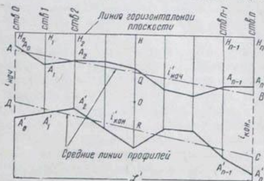
Рис. 2. Профили, построенные по точкам начал и концов средних линий профилей створов: A_0, A_1, A_2, \dots, A_n — точки начал средних линий профилей створов; A'_0, A'_1, A'_2, \dots, A'_n — точки концов средних профилей створов; H_0, A_0, H_1, A_1, \dots, H_n, A_n — ординаты средних линий; H'_0, A'_0, H'_1, A'_1, \dots, H'_n, A'_n — ординаты концов средних линий; HQ — средняя ордината начал средних линий; HR — средняя ордината концов средних линий; HO — ордината центра поля (средняя ордината начал и концов средних линий); ABCD — проектная поверхность, представленная в вертикальной плоскости;
