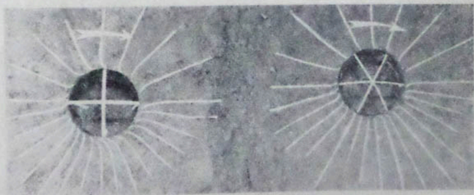
Рис. 3. Деформация грунта при сдвиге.
