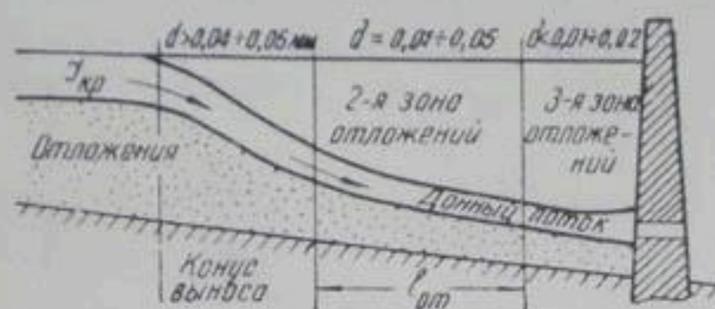
Рис. 1. Схема расчета заиления водохранилищ при образовании донного потока (по И. И. Леви).
