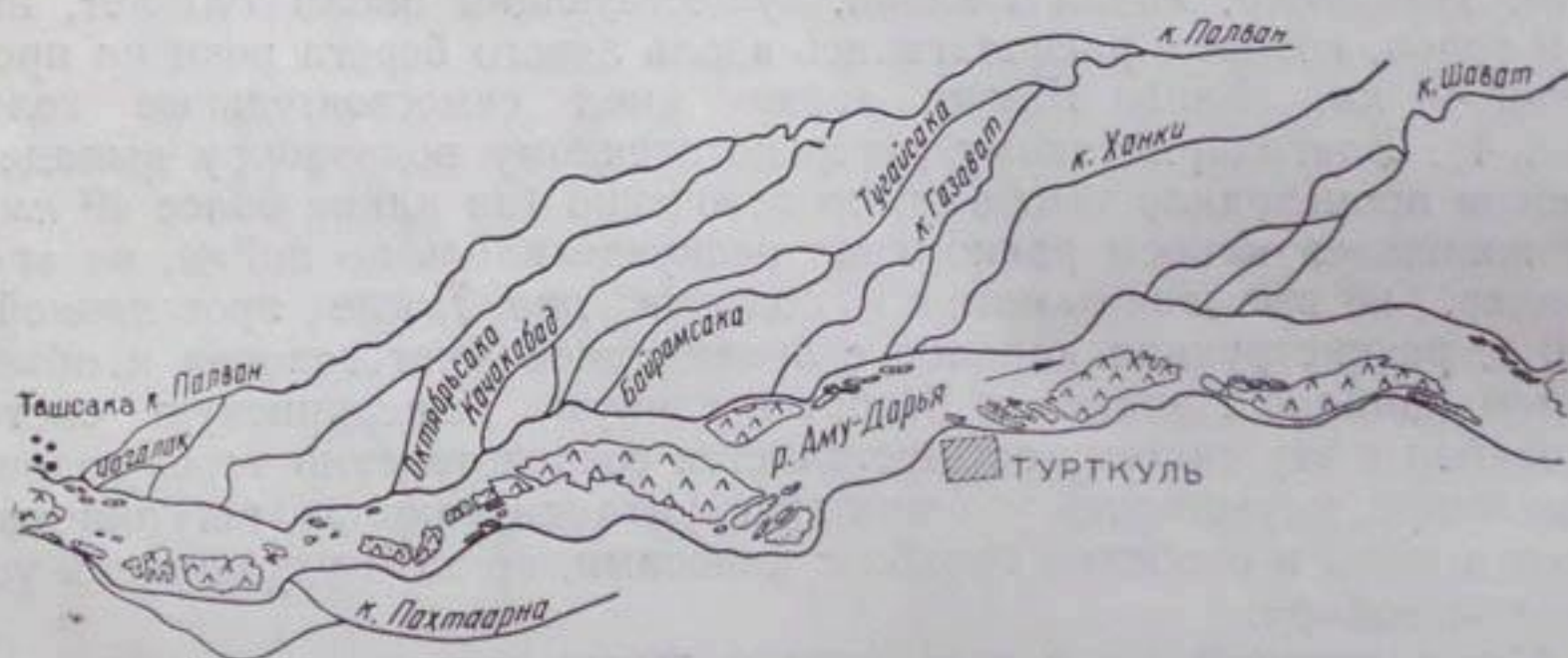
Рис. 4 Многоголовый водозабор из р. Аму-Дарья в каналы Палван и Шават по съемке 1937 г.
