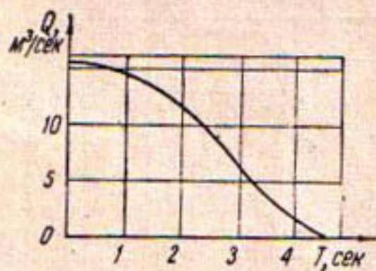
Рис. 3. Кривая изменения расхода при постоянном напоре H_0 = 125 м от времени T .
