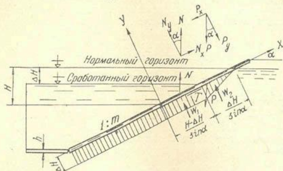
Рис. 2. Схема расчетных нагрузок облицовки:
