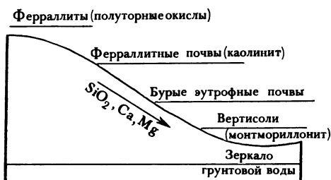
Рис. 6. Сопряженное распределение почв на базальтовом склоне в тропиках (по Ф. Дюшофуру, 1970)
