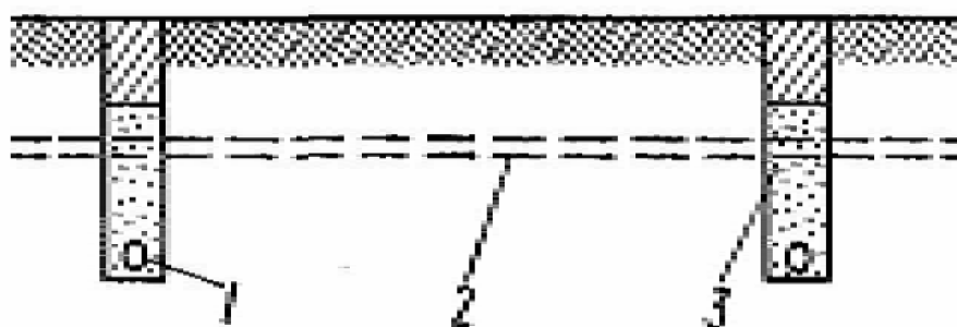
Рис.16.1 Комбинированный дренаж: 1 – гончарная дрена; 2 – кротовина, 3 – фильтрующая засыпка
