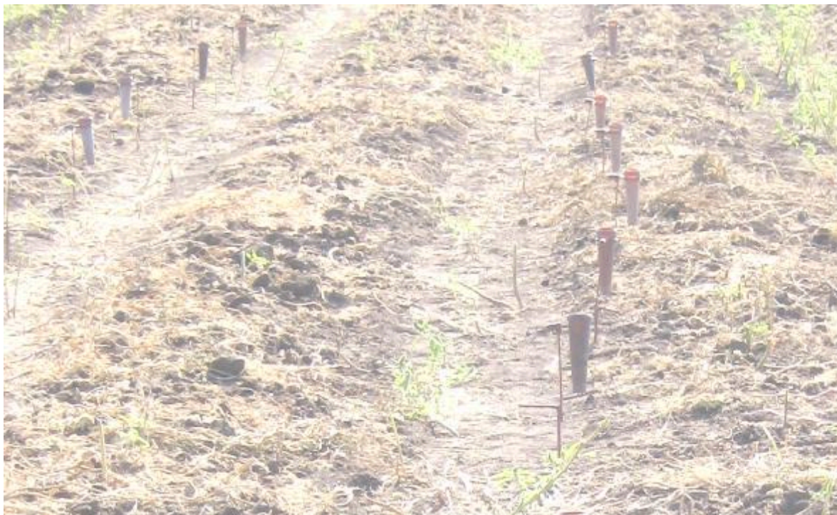
Рис. 10. Схема расстановки дождемерных бачков при поливе ДКФ-1ПК
