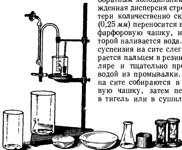
Рис. 13. Прибор Сабанина для механического анализа почвы
