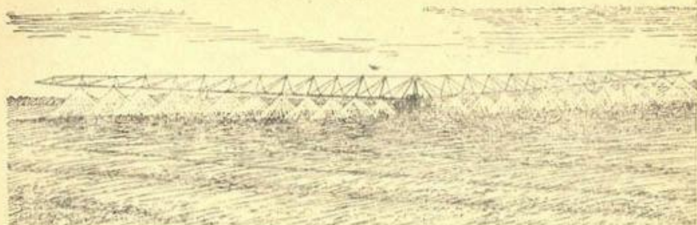
Рис. 54. Двухконсольный дождевальный агрегат ДДА-100МА в работе.
