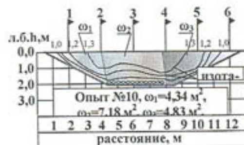
Рисунок 2 - Распределение продольных скоростей потока в изотахах (Большой Алматинский канал ПК954, продолжение рисунка).
