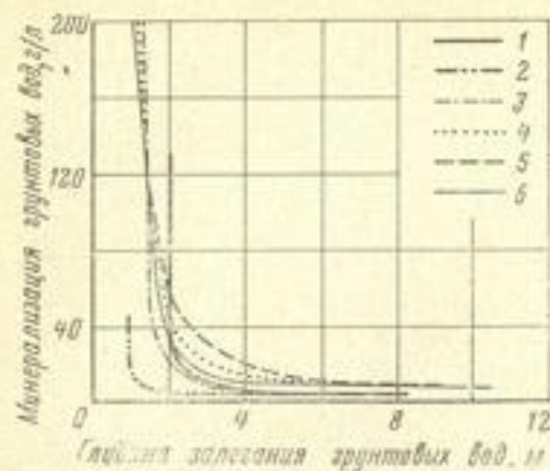
Рис. 10. Зависимость между глубиной и степенью минерализации грунтовых вод: 1 — Аму-Дарья (дельта); 2 — Прикаспийская низменность; 3 — Кузунда; 4 — Голодная степь; 5 — Вахши; 6 — Бараба
