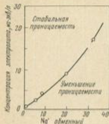
Рис. 19. Концентрация электролита, необходимая для поддержания проницаемости почв при различном содержании обменного \text{Na}^+ (Quirk, Schofield, 1955)
