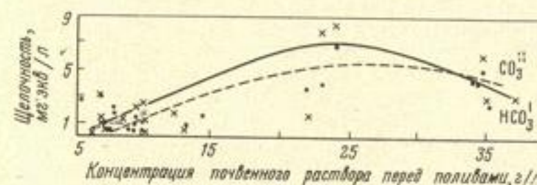
Рис. 17. Щелочность почвенных растворов в зависимости от их концентрации
