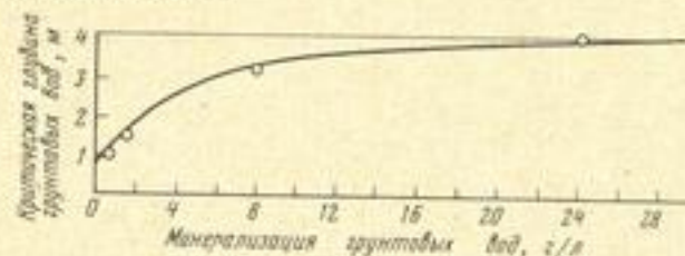
Рис. 2. Влияние минерализации грунтовых вод на засоление почв
