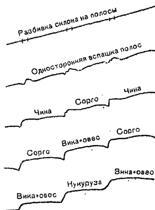
Рис. 16. Схемы смены культур и формирования напашных террас при полосной распашке склонов
