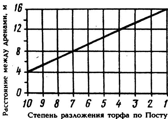
Рис. 4.5. Расстояние между кротовыми дренами в торфяных почвах в зависимости от степени разложения торфа (по Эггельсманну, 1984)
