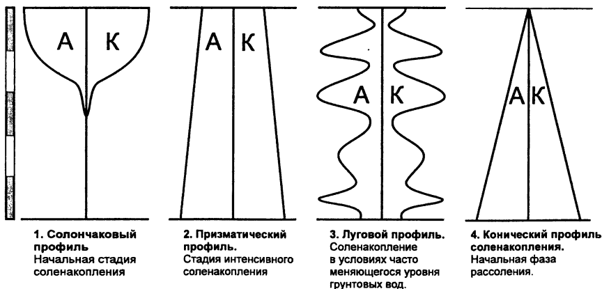
Рис. 5.7. Эпюры распределения катионов (К) и анионов (А) водорастворимых солей по профилям почв на разных стадиях засоления и рассоления
