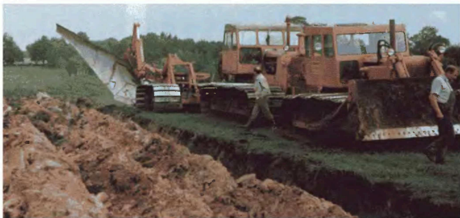
Рис. 16. Плуг В. Оттомайера и тракторный агрегат для создания немецкой песчаной смешенно- слойной культуры земледелия на осушенных торфяных почвах
