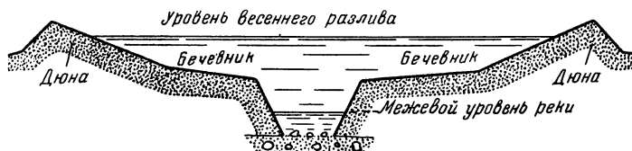
Рис. 5. Схема поперечного разреза русла реки при образовании зернистой поймы.
