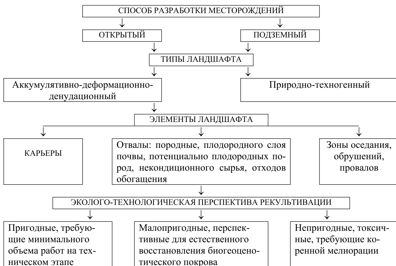
Рис. 2. Схема элементов техногенного ландшафта горнорудных районов (Чайкина, Объедкова, 2003)
