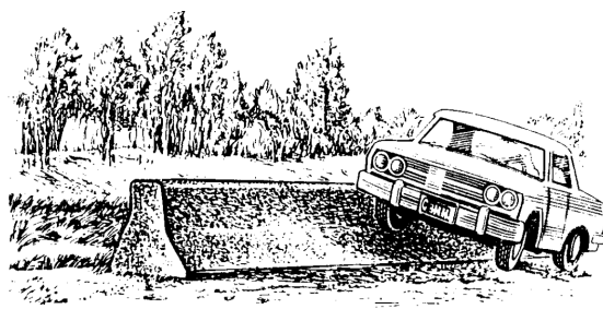
Рис. 6.17. Бетонное ограждение, изменяющее направление движения автомобиля.
