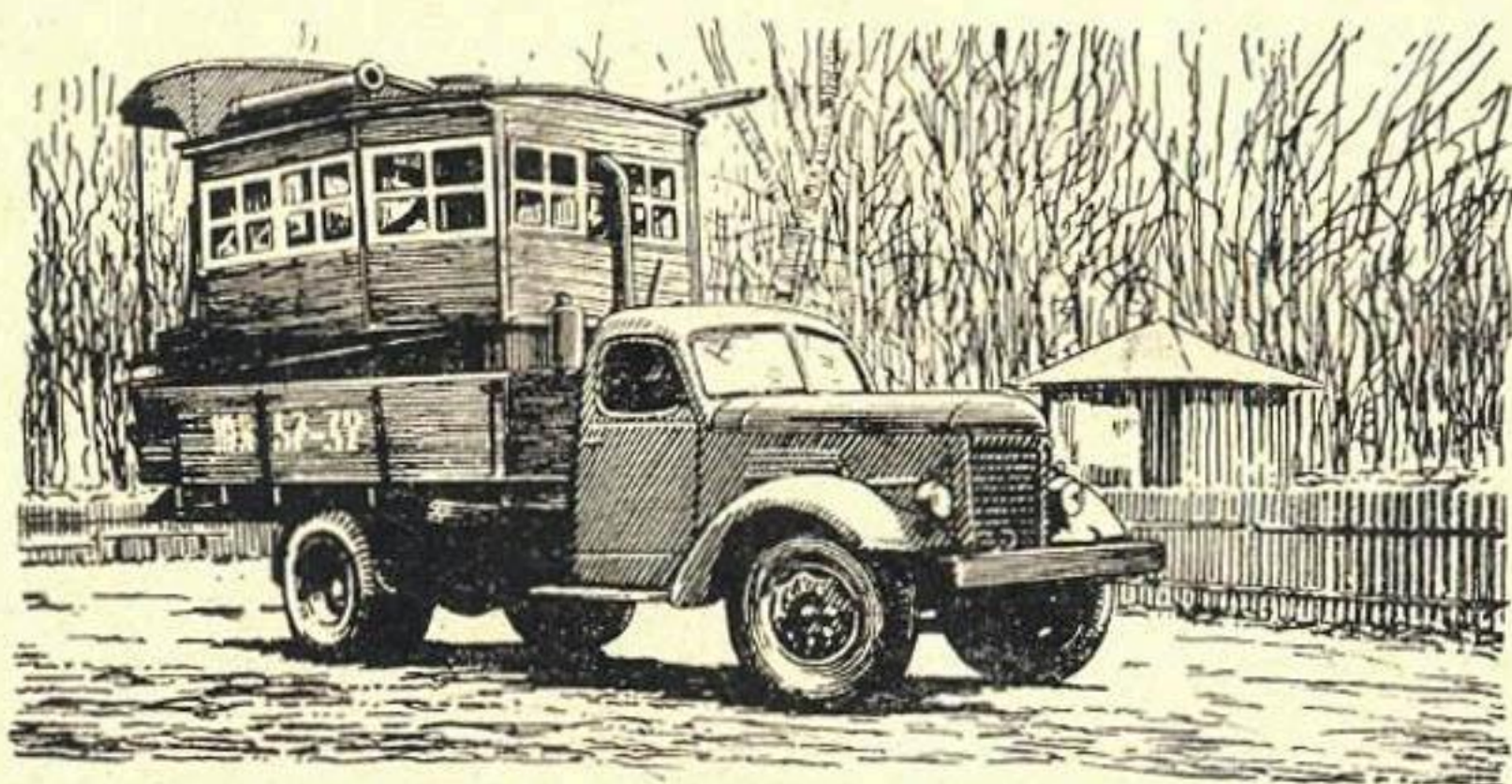
Рис. 108. Перевозка землесосной установки 4ПЗУ-ВНИИГиМ на автомашине.
