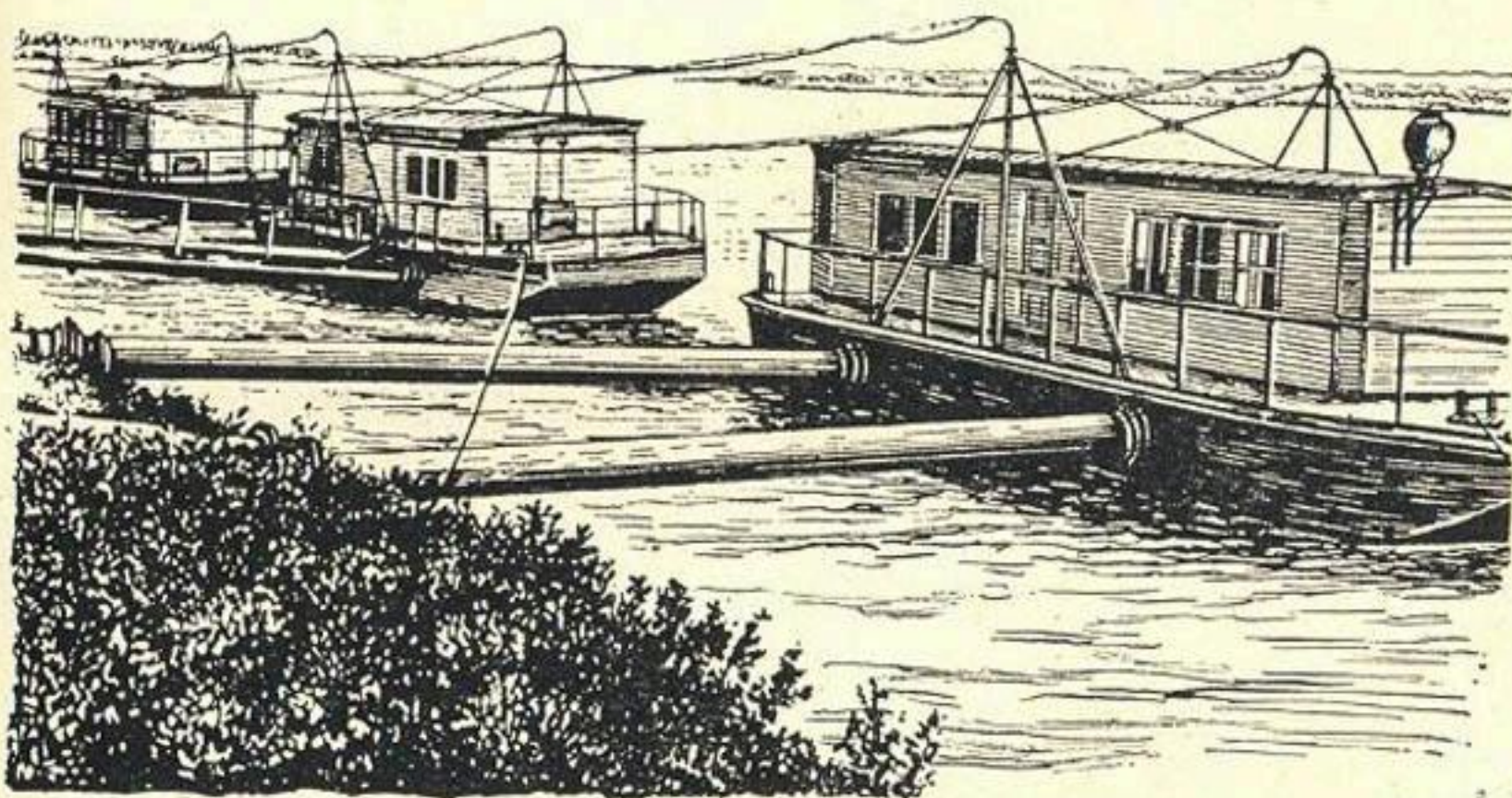
Рис. 10. Плавучие электрифицированные насосные станции.
