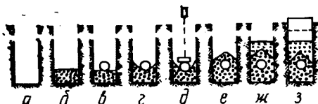
Рис. 78. Схема технологического процесса, выполняемого дренукладчиком Д-251
