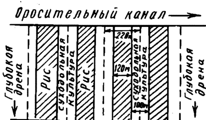
Рис. 91. Схема расположения посевов при двухтактной форсированной промывке
