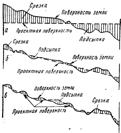
Рис. 37. Типы проектной поверхности поливных участков (по Г. Г. Подгорнову):
