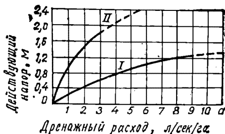
Рис. 65. Зависимость расхода воды в дренах от действующего напора:
