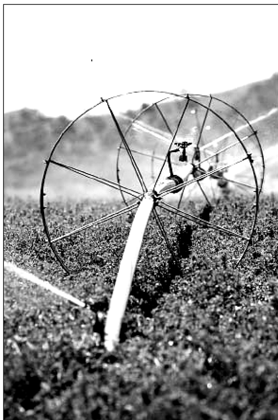
Рис 7.5. Дождеватель колесный широкозахватный ДКШ-64 “Волжанка”.
