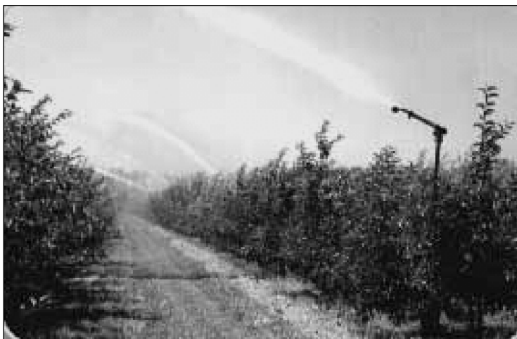
Рис. 6.2. . Дождевальный аппарат ДД-30 на трубопроводе: 1 - трубопровод; 2 - стояк; 3 - затвор; 4 – дождевальный аппарат ДД-30.
