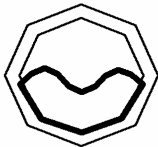
Рис 4.4.1. Прокладка жесткой сплюсненной трубы внутри старой
