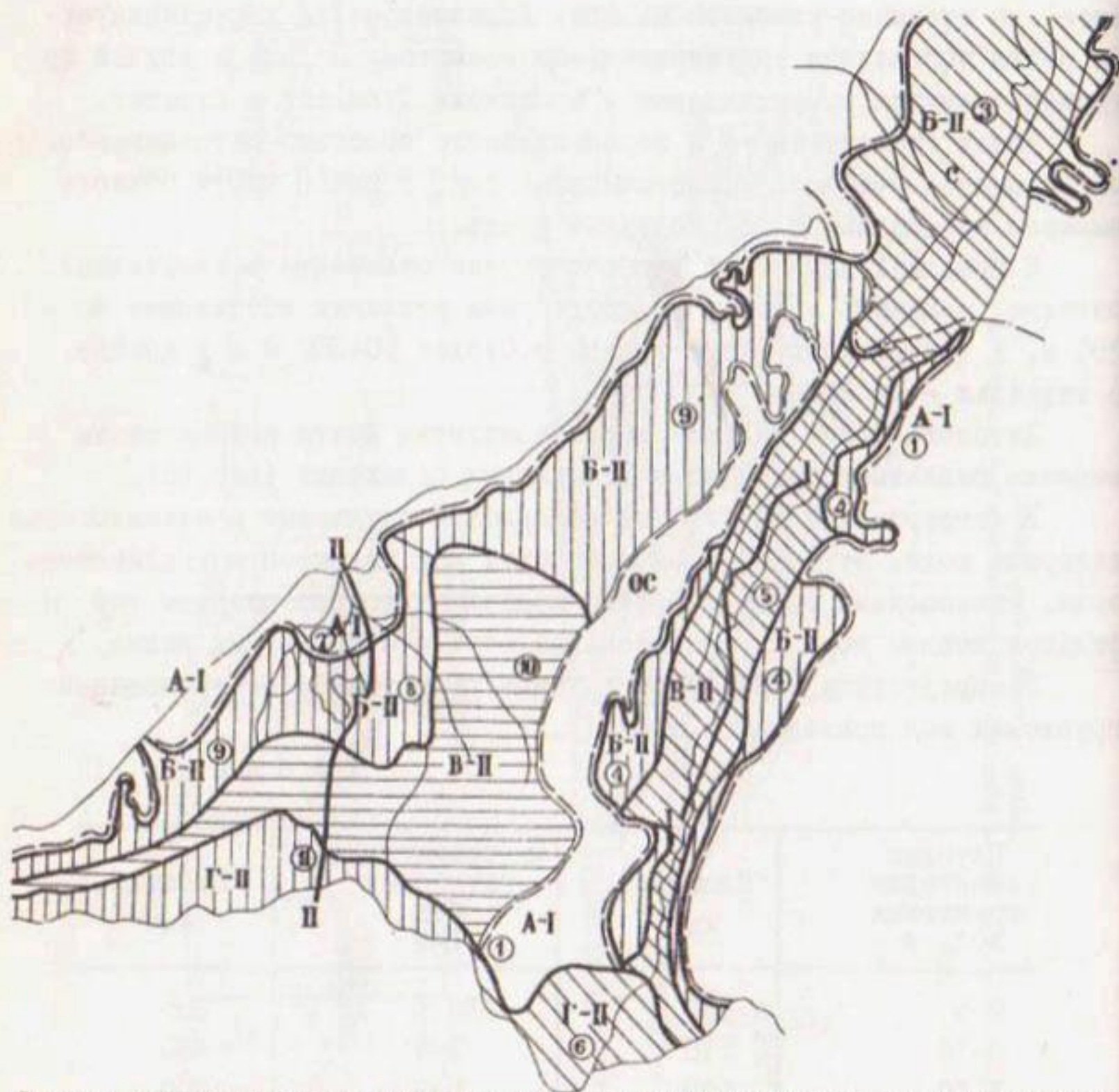
Рис. 44. Карта гидрогеологического районирования Зеравшан-Сурхандарьинской межгорной депрессии в связи с оценкой условий применения вертикального дренажа (Условные обозначения см. по рис. 37)
