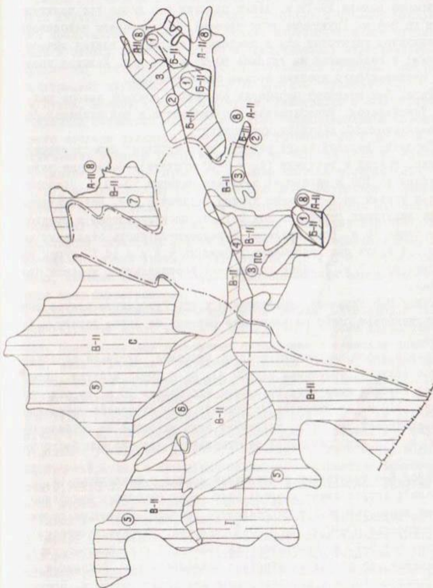
Рис. 46. Карта гидрогеологического районирования Каримовского оазиса в связи с оценкой условий применения вертикального дренажа (Условные обозначения см. по рис. 37)
