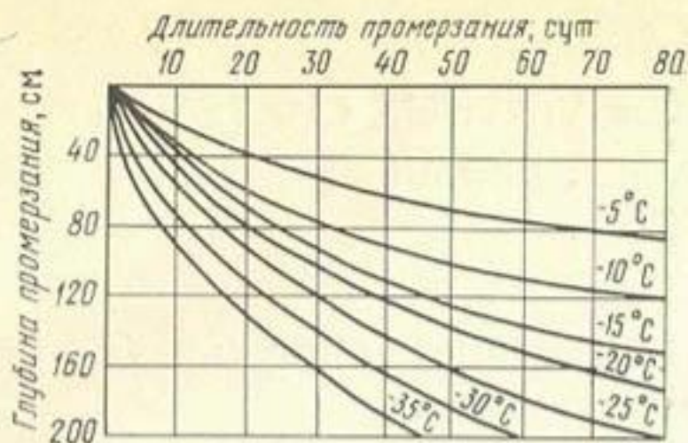
Рис. 5.1. Зависимость глубины промерзания от температуры и длительности промерзания.
