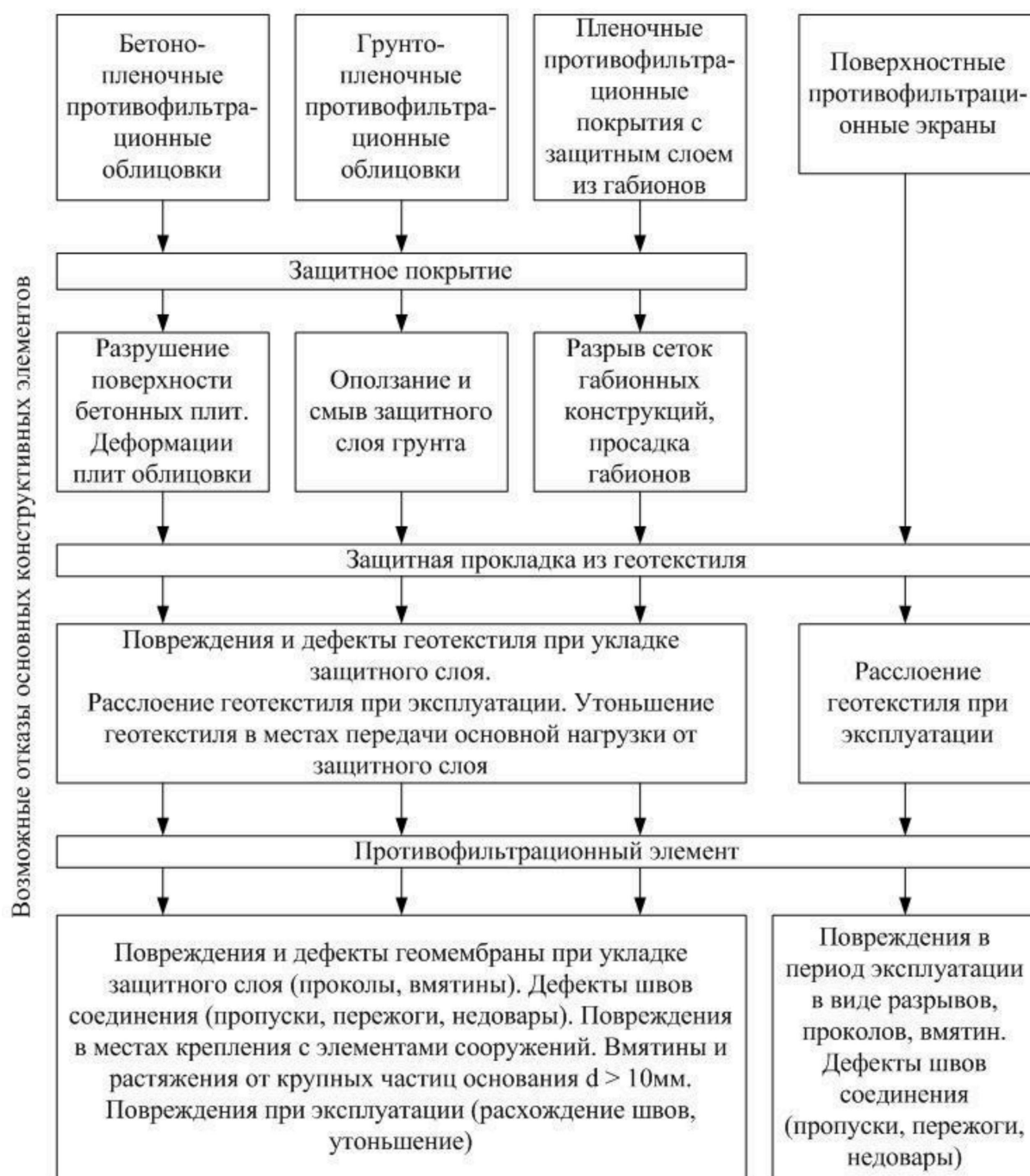
Рисунок 3 – Виды отказов конструктивных элементов противофильтрационных облицовок
