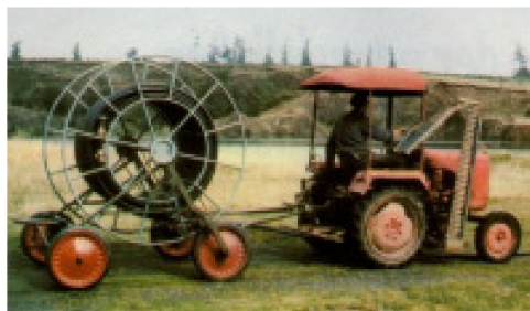
Первое применение барабанной оросительной установки
