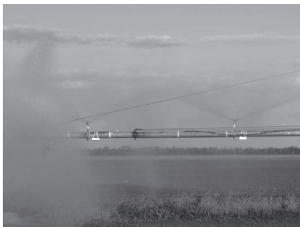
Работа моторизованного крана с установленной форсункой ВолжНИИГиМ
