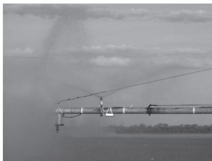
Работа моторизованного крана с установленной форсункой ВолжНИИГиМ
