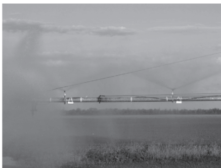
Работа моторизованного крана с установленной форсункой ВолжНИИГиМ
