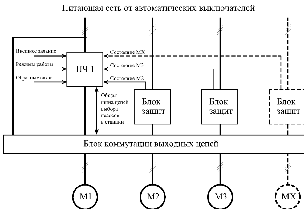
Рис. 2. Функциональная схема системы управления насосной станцией с одним преобразователем частоты: M1, M2, M3, MX – асинхронные электродвигатели насосов в станции; ПЧ 1 – преобразователь частоты
