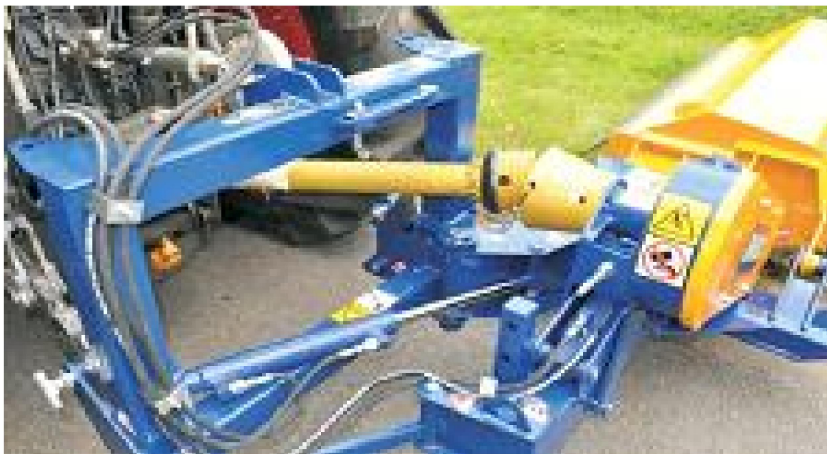
Рисунок 8 – Режущий аппарат на шарнирно-параллелограммной подвеске
