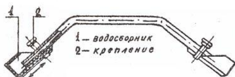
Трубка-сифон неразряжающийся ТСН-25
