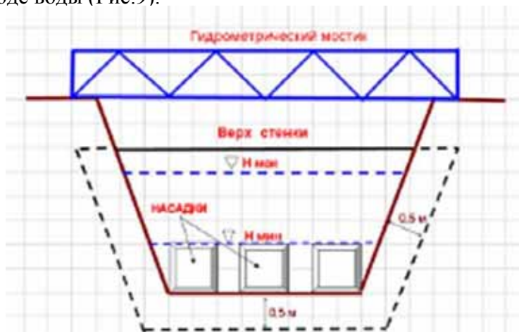
Рис.9. Водомерное устройство типа «СНС»
