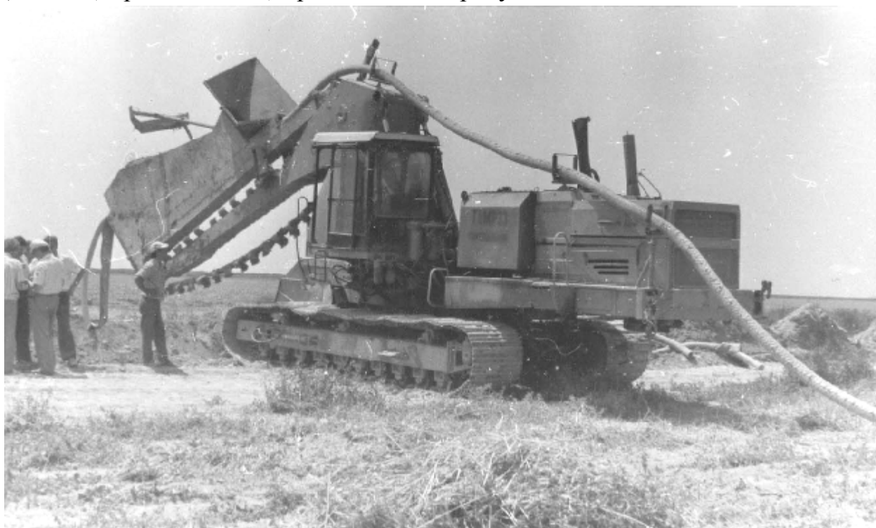
Рисунок 1- Общий вид дреноукладчика «Арал» (ДУ- 4001)
