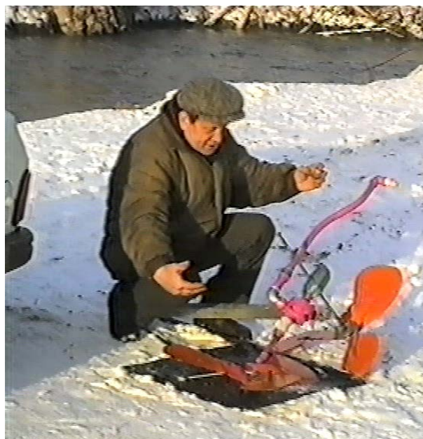
Фото 1 - Переносной свободно-поточный турбонасосный агрегат
