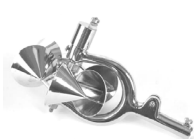
Рис. 9. Вертушка Прайса USGS TYPE AA-MH MODEL 6215 (Rickly Hydrological Company, США) (по [12; 19])
