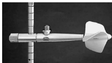
Рис. 6. Малый ИСП С2 и преобразователь сигналов Z-215 (ОТТ-Hydrometrie, г. Кемптен, Германия) (по [18])
