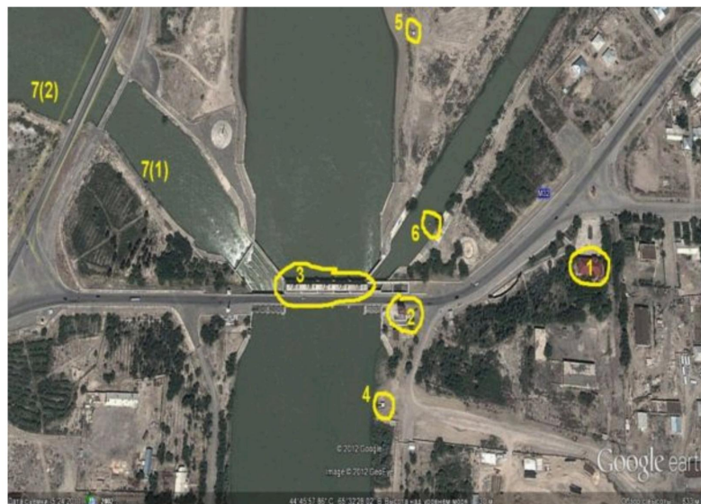
Рис. 1. План установок автоматизированных технических средств контроля: 1- диспетчерская; 2- шкаф с контроллером; 3- плотина. 4- ультразвуковой датчик уровня воды верхнего бьефа; 5- датчик уровня воды нижнего бьефа; 6- ультразвуковой датчик правобережного канала; 7- датчик уровня левого канала, устанавливаемый в позиции 7(1) или в позиции 7(2).
