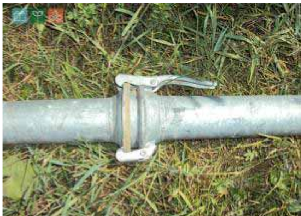
Рис. 10. Быстроразъемное соединение металлических труб
