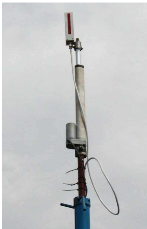
Рисунок 3 - Установка актуатора АК-1, сверху-вниз: приемник, актуатор с выдвижным штоком, телескопическая мачта с механическим зажимом
