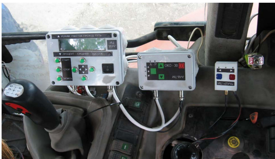
Рисунок 4 – Совмещение в кабине трактора пультов управления, слева направо: автонивелира АН-3, лазерно-приемного устройства ОКО-30, курсового навигатора КН-1 и актуатора АК-1
