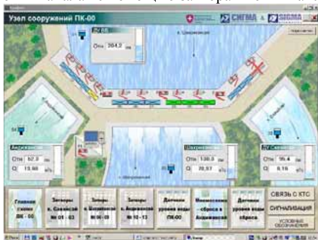
Рис. 7. Кампирраватский гидроузел главная мнемосхема системы SCADA
