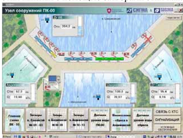
Рис. 7. Кампирраватский гидроузел главная мнемосхема системы SCADA
