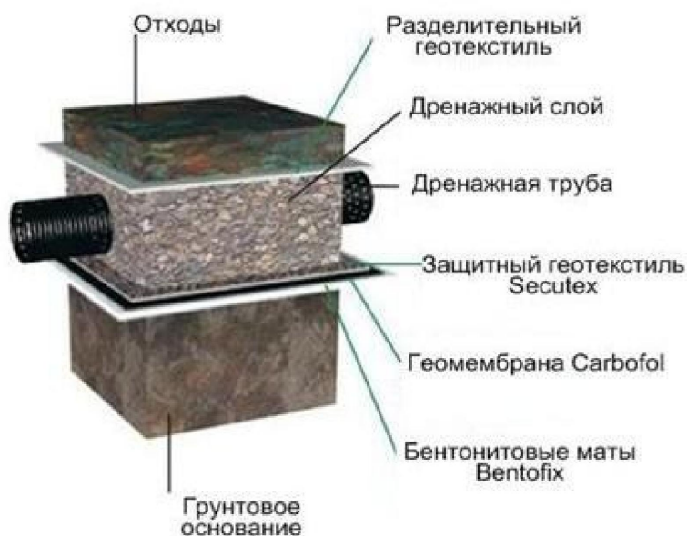
Рисунок 4 – Конструкция функциональных слоев основания накопителей от NAUE
