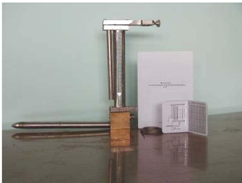
Рис. 4. Гидродинамический измеритель скорости потока ГТР
