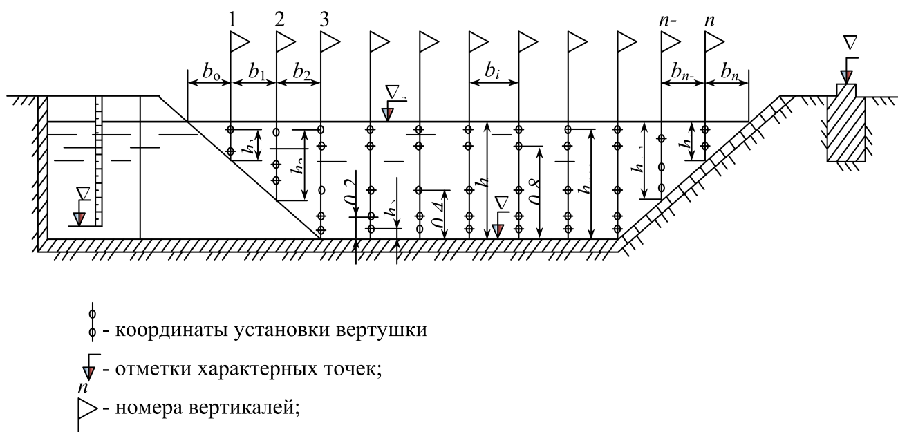
Рис .6. Схема разбивки вертикалей по поперечному сечению канала
