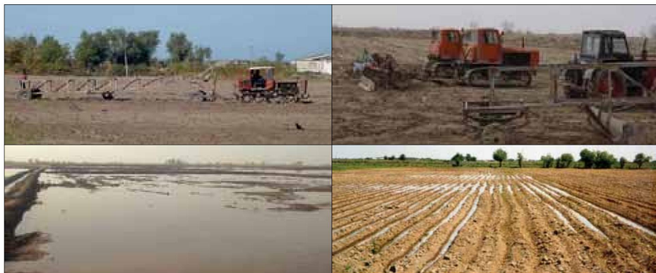
Рис. 1. Длиннобазовый планировщик, мола выравнивающая, и неровности на полях приводящие к неравномерному распределению воды
