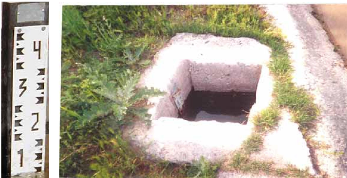
Рис. 10. Средства измерения уровня воды а) гидротехническая рейка б) успокоительный колодец
