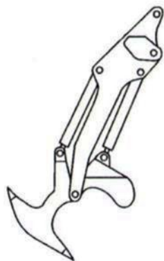
Рис. 1.65. Корчеватель экскаваторного типа «Pallary»
