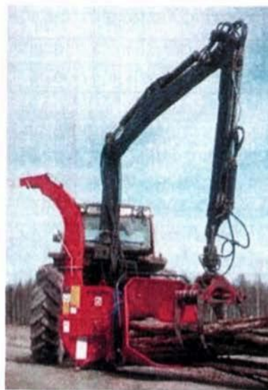
Рис. 1.60. Измельчение короткомерной древесины рубильной машиной CH260 HF-2EL
