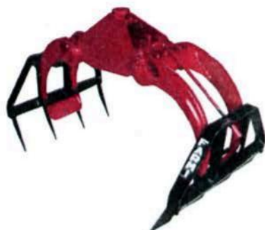
Рис. 1.56. Грейфер челюстного типа, оснащенный уширителями с зубьями
