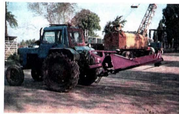
Рис. 1.32. Маятниковый кусторез на базе трактора МТЗ-80
