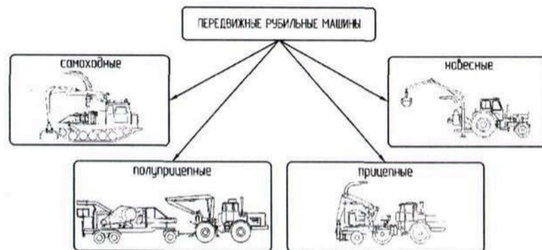
Рис. 1.59. Разделение передвижных рубильных машин по принципу агрегатирования
