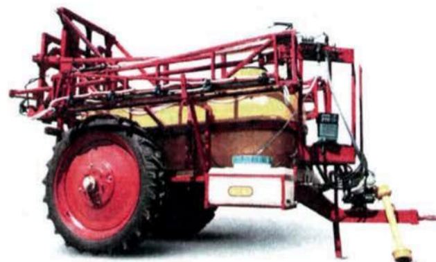
Рис. 1.68. Опрыскиватель прицепной штанговый
