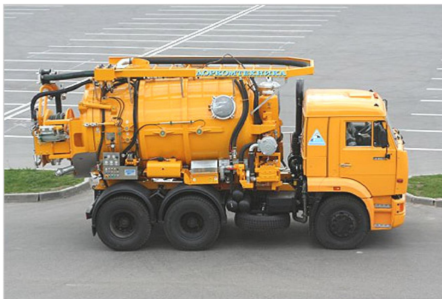
Рис. 1. Машина ДКТ-225 с обогревателем воды для эксплуатации до -10^{\circ}\text{C}
