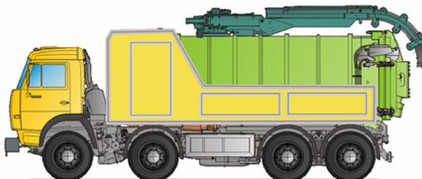
Рис.2. Илосос ДКТ-325 с всасывающим рукавом на стреле
