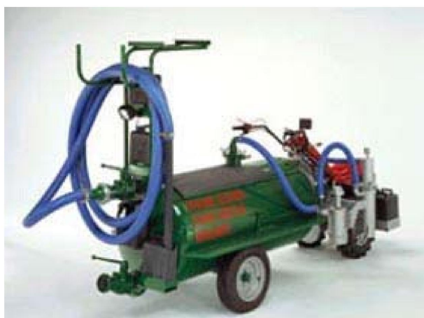
Dung Beetle – вакуумная установка (илосос)
