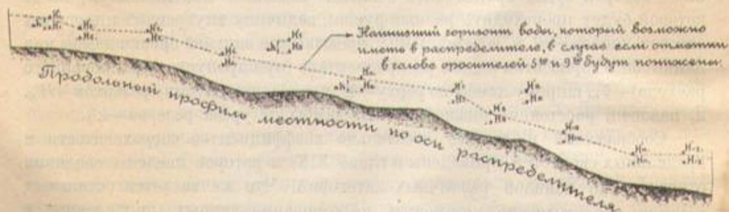
Черт. 209. Схема определения горизонтов воды в распределителе.
