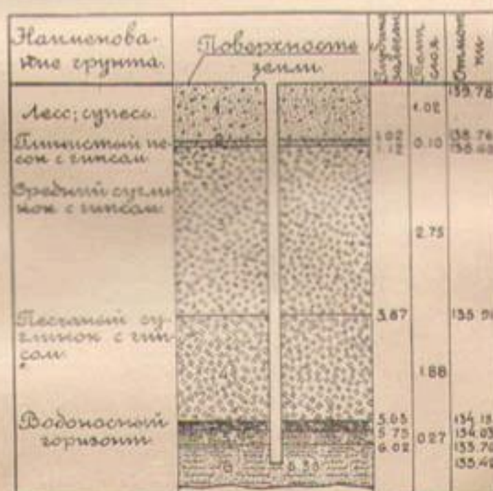
Черт. 154. Желательная форма окончательной обработки данных по шурфованию и бурению вдоль канала.
