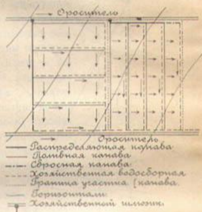
Черт. 218 и 219. Разбивка мельчайшей сети на поселенческом участке при равномерном уклоне местности.
