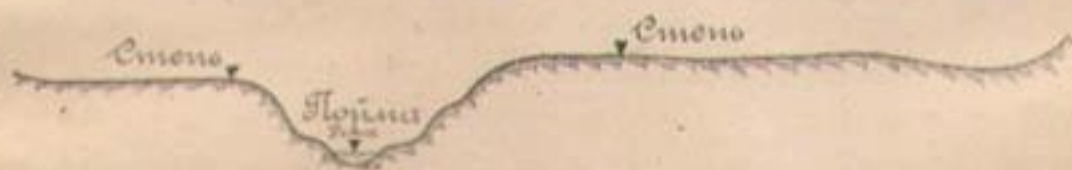
Черт. 47. Поперечный профиль реки и прилегающей степи для предгорного типа рельефа.
