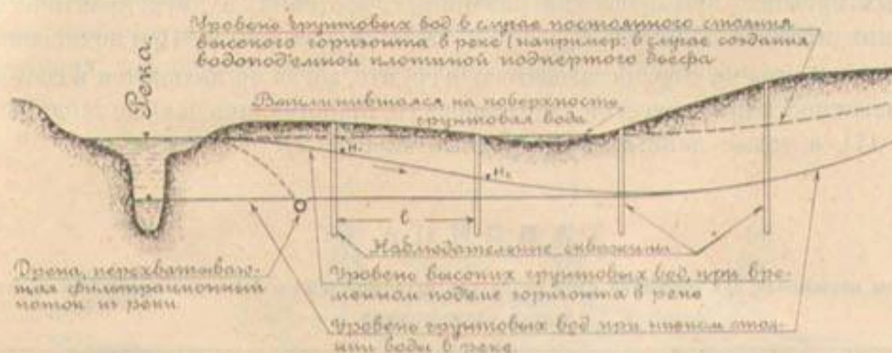
Черт. 285. Разрез по линии наблюдательных скважин (см. черт. 284).
