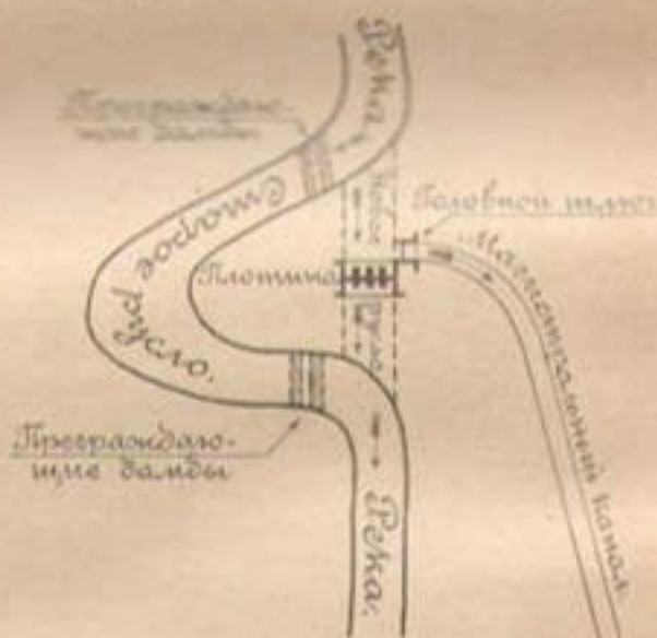
Черт. 137. Схема расположения плотины на сухом месте с последующим прорывом нового русла и закрытием старого.
