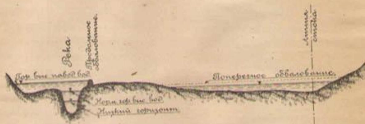
Черт. 43. Тот же поперечный разрез с защитой от затопления всей местности, в виде продольного обвалования.
