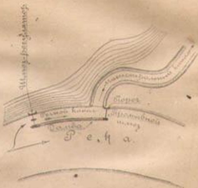
Черт. 21. Подводящее русло с захватной шпорой, со шлюзом-регулятором в верхней части.
