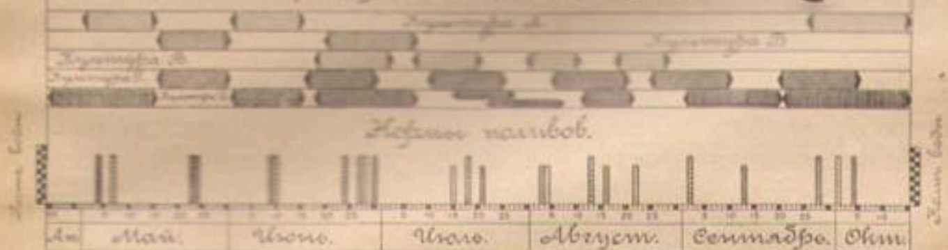
Черт. 81. Графики отдачи воды на поля и графики потребления воды из источника орошения при различном распределении культур и разных коэффициентах полезного действия.
