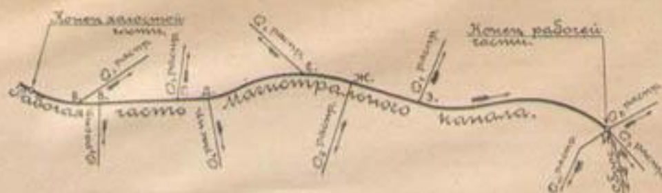
Черт. 167. Схематический план рабочей части магистрального канала с показанием выводов распределителей.
