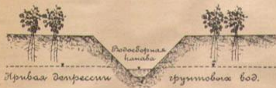
Черт. 39. Типовое поперечное сечение водосборной канавы.
