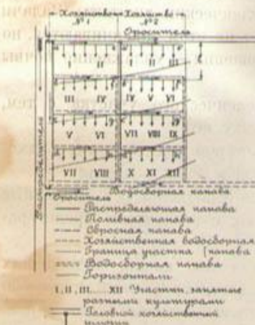
Черт. 213. Разбивка мельчайшей сети на поселенческом участке при равномерном уклоне местности.
