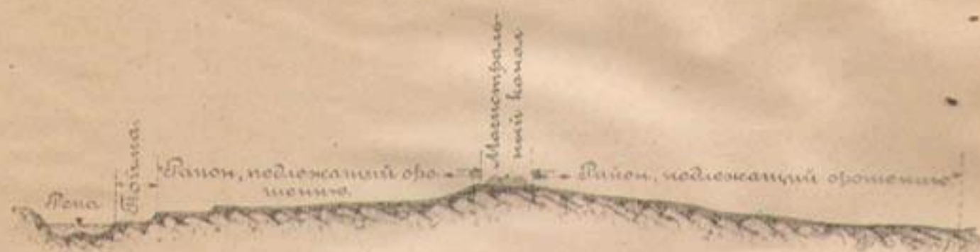
Черт. 31. Разрез местности по линии ската (двускатный рельеф).
