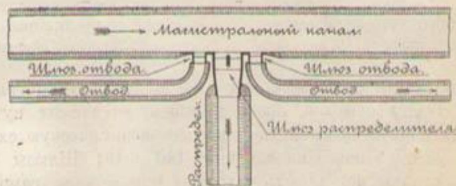
Черт. 191. Схема узла А; шлюзы отводов устроены в крыльях шлюза-распределителя.
