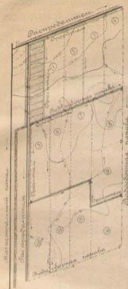
Черт. 183. Пример разбивки трассы оросителя, водосборной канавы, усадебных и полевых участков поселенцев на площади одной единицы водопользования (см. условн. обознач. черт. 181 и 182).
