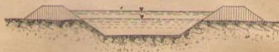
Черт. 37. Типовое поперечное сечение распределителя.
