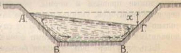
Черт. 180. Схема движения воды на закруглениях.
