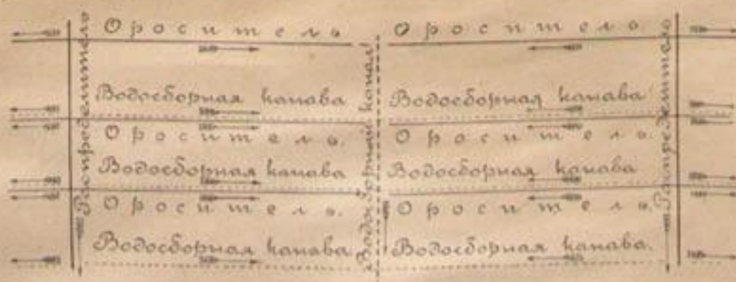
Черт. 41. Схема, показывающая примерное взаимное расположение распределителей, оросителей, водосборных каналов и водосбросных каналов.
