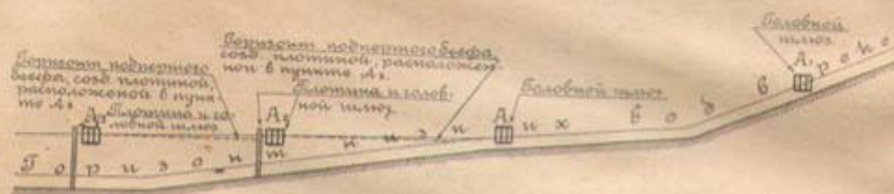
Черт. 132. Схематический продольный разрез по реке с показанием головных сооружений по различным вариантам.
